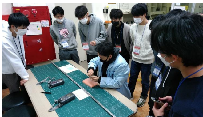
図 3.8-2 放射化した金線の測定準備
