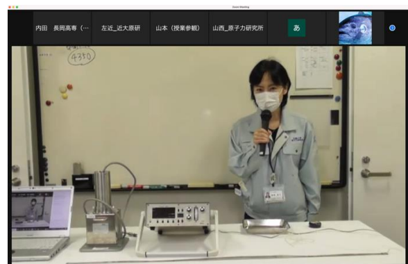
図 3.5-2 GM 計数管による放射化試料の測定
