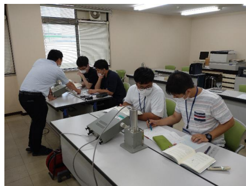
図 3.5-4 GM 計数管による放射化試料の測定。
