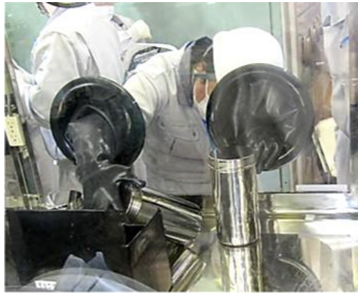
図 3.2-4 模擬 GB による核物質取扱教育の例
