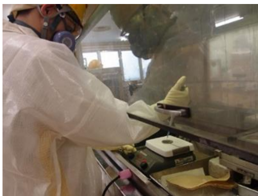
図 3.2-5 ウラン溶液を用いたフード作業の例
