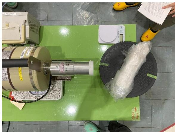
図 3.6-2 放射性廃棄物計測実習において黒鉛を炉室にて測定している様子
