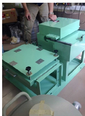
Ge 検出器用 \gamma 線遮蔽体 (中性子減速・拡散実験で使用)
