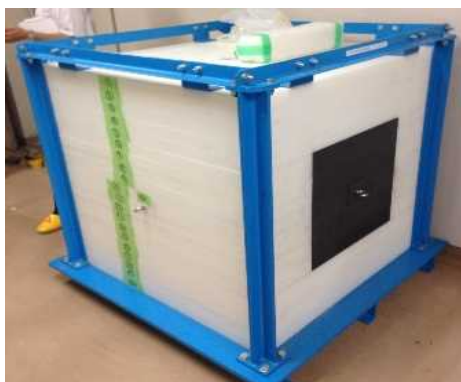
ポリエチレン・黒鉛減速体 (中性子減速・拡散実験で使用)
