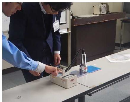
図 3 原子炉物理実習 （放射線測定機器による作業環境測定）
