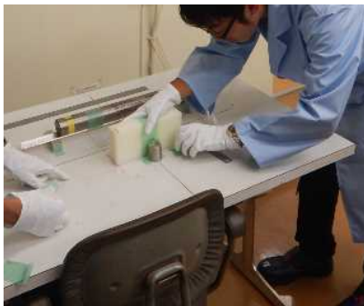
図 1 原子炉物理実習 （中性子源を用いた中性子の減速特性）
