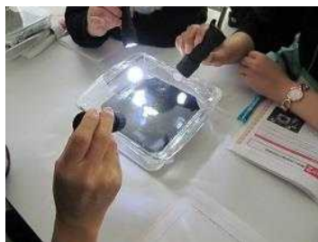
写真3 トレーナーズトレーニング研修 実習1霧箱を用いた放射線の飛跡観察
