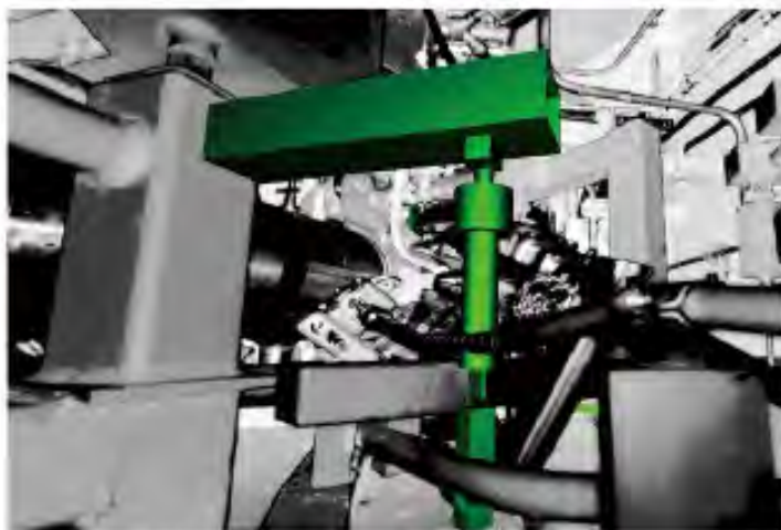
配管支持装置設置後の3次元データ
