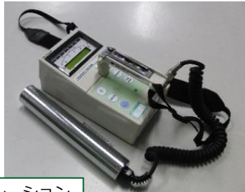
NaI(Tl)シンチレーションサーベイメータTCS-172B (日立アロカメディカル)
